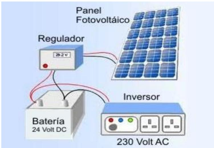
La energía solar es captada por los paneles fotovoltaicos. La energía no utilizada se almacena en baterías como energía química para usarse durante los días de lluvia o nublados
